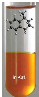
**Höhere Überlebenschancen für teure Katalysatoren:** Der Einsatz von Propylenkarbonat als Lösungsmittel bei der iridiumkatalysierten Hydrierung nichtfunktionalisierter Olefine ermöglicht ein effizientes Katalysatorrecycling durch Bildung von Zweiphasengemischen mit unpolaren Lösungsmitteln wie *n*-Hexan.
