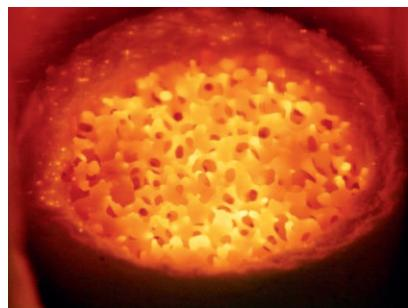
**Koksfrei:** Thermische Zersetzung und katalytische partielle Oxidation wurden zu einer effektiven Methode für die Umwandlung von fester Biomasse wie Cellulose in Synthesegas gekoppelt (das Foto zeigt die heiße Oberfläche eines Rh-Katalysators). Der Prozess ist schnell, und er verläuft ohne die Bildung von Koks, der Katalysatoroberflächen deaktivieren und Oberflächenreaktionen blockieren würde.
